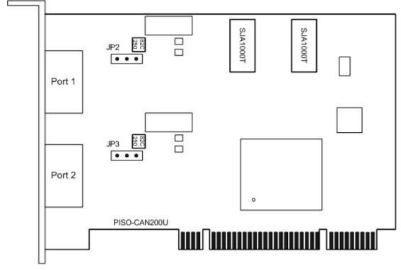
Figure2.3 PISO-CAN200U Board LAYOUT
